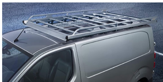
Alumínium tetőcsomagtartó L1 járműhosszhoz, 140kg teherbírás
