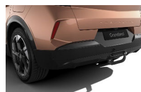
Szerszám nélkül leszerelhető vonóhorog 13 pólusú csatlakozóval
